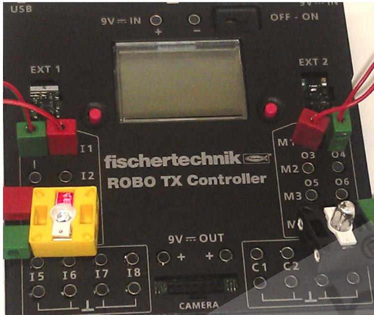
之后，在 ROBO Pro 软件的接口测试窗口中进行正确的传感器输入类型设置，本实验中，我们将 I1 输入端口的类型设置为“Digital 5kOhm ( Switch )”，如下图所示：
