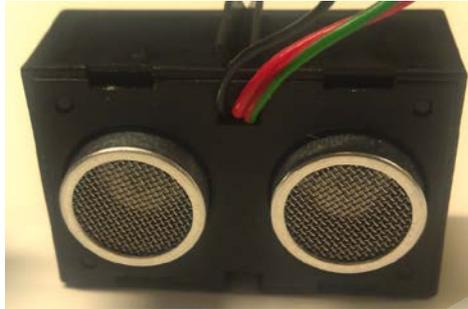
超声波传感器有 3 跟电线，其中红色电线需要接到控制器上的 9V 电源输出，绿色电线可以接到控制器上的任何“地”，本例中，接到 I1 输入端子组中的“地”。这些在下面用红色圈出。
